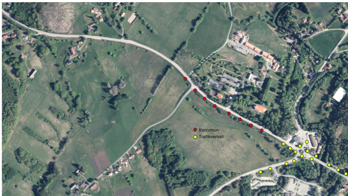
Figur 7. Belysningsstolpar tillhörande Trafikverket (gult) och Bollebygds kommun (rött) längs väg 554.
