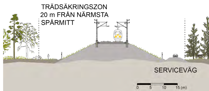
Figur 9: Förenklad illustration av typsektion för järnväg på bank.
