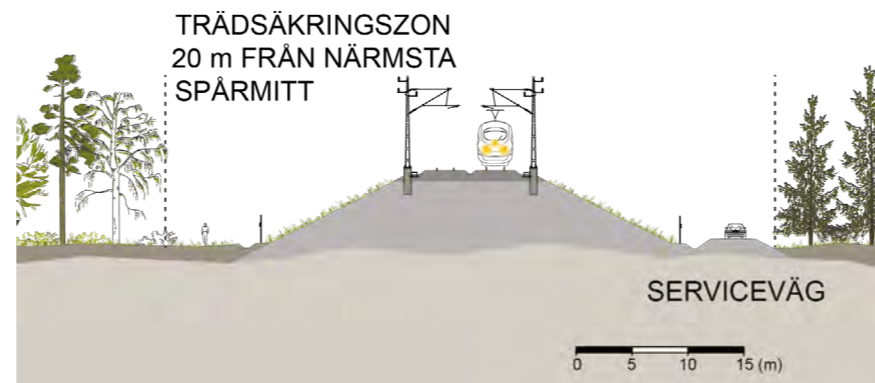
Figur 9: Förenklad illustration av typsektion för järnväg på bank.
