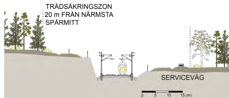
Figur 10: Förenklad illustration av typsektion för järnväg i skärning.
