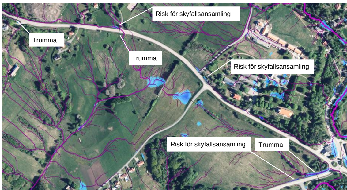
Figur 19. Flödesvägar och skyfallsansamlingar vid 50 mm regn (källa: underlag från Scalgo Live).
