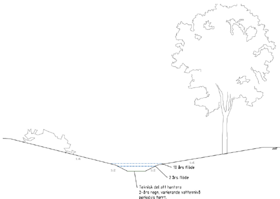
Principsektion för centralt dikesstråk
