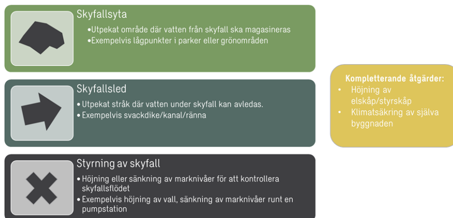
Figur 11. Schematisk illustration av tänkbara skyfallsåtgärder.
