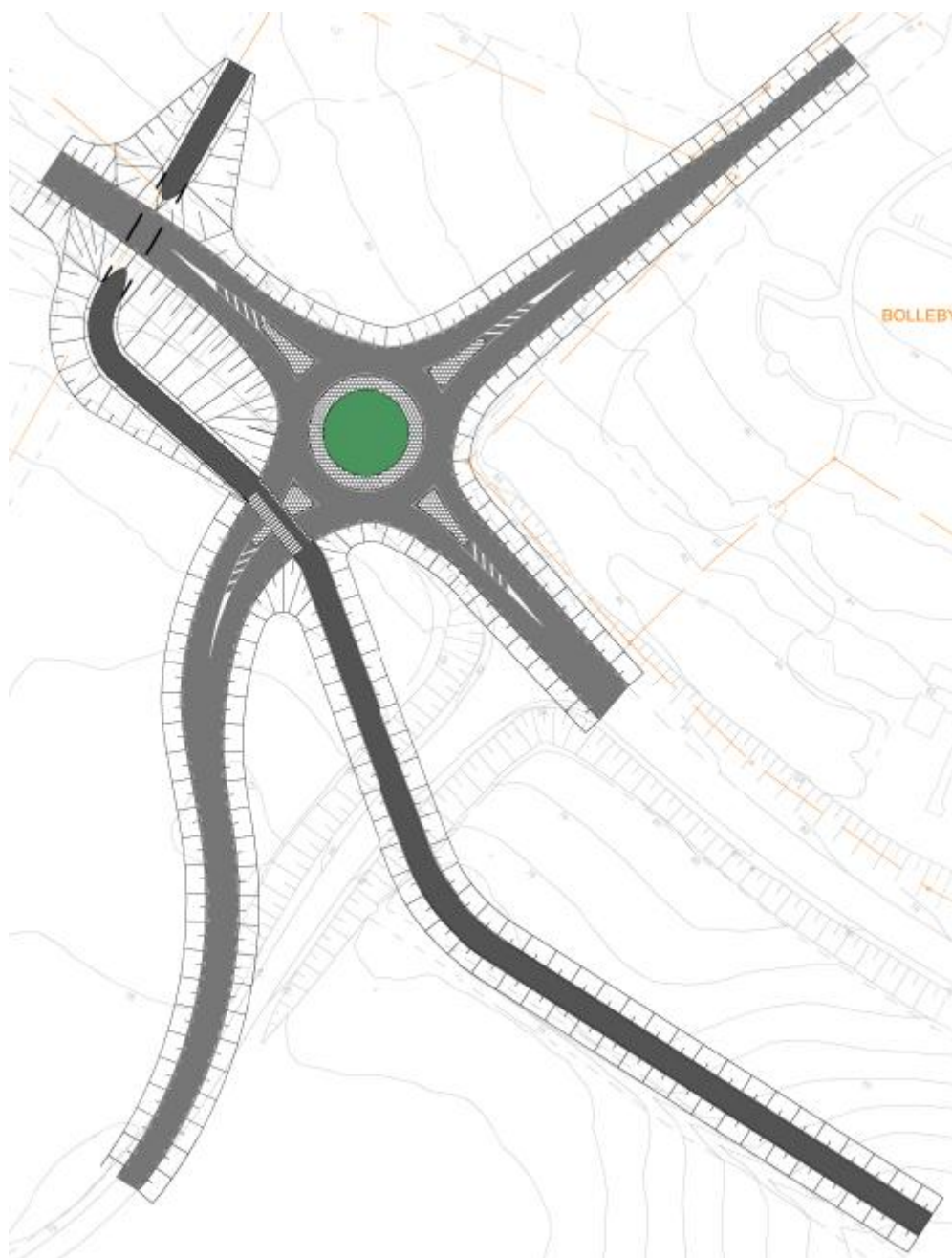
Utformning med planfri GC-passage under Hindåsvägen.
