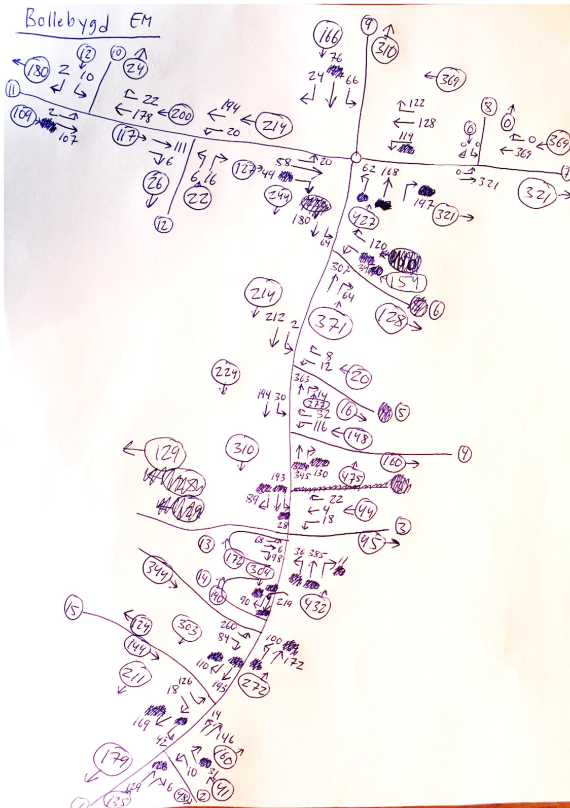
Flöden för nuläget som baseras på trafikräkningen för EM-rusningen [f/h] (med nodnummer).
