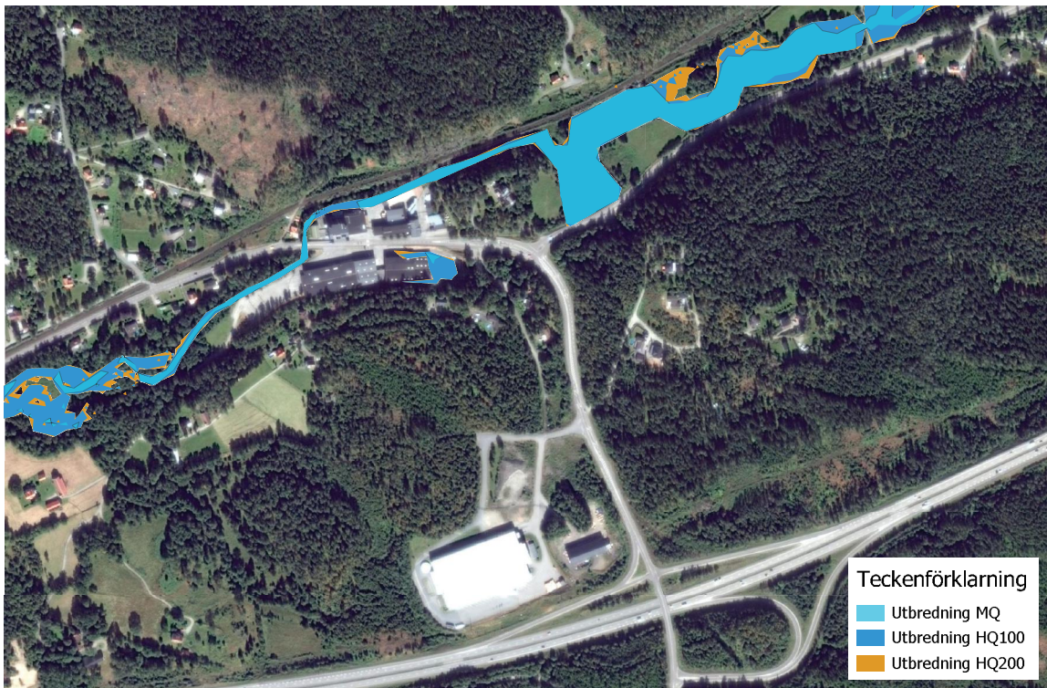
Översiktlig översvämningsutbredning för Sörån. Nivåer motsvarar medelvattenföringen (MQ), ett flöde med 100 års återkomsttid (HQ 100) och ett flöde med 200 års återkomsttid (HQ200).
