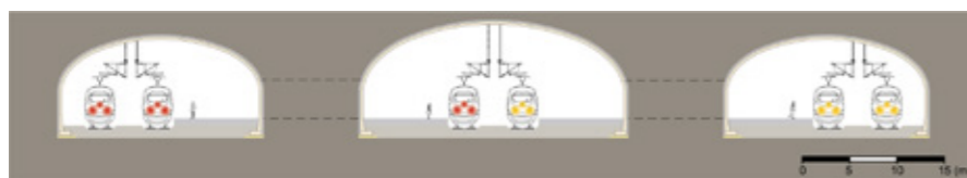
Figur 3.5 Schematisk sektion för station i bergtunnel med sex spår.
