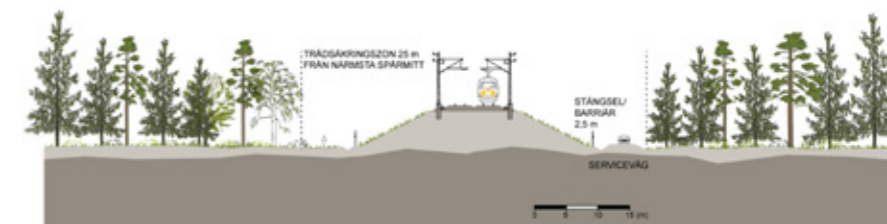
Figur 3.10 Illustration när järnväg går i bank.
