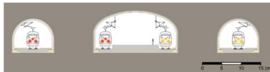
Figur 3.6 Schematisk sektion för station i bergtunnel med fyra spår.
