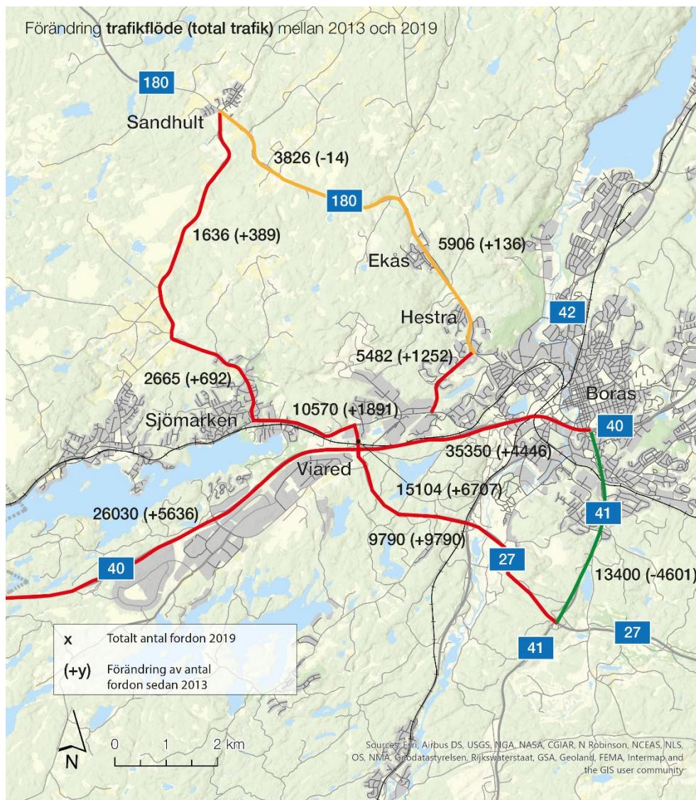
Figur 10 Förändring av totaltrafik (årsdygnstrafik) i och med öppning av väg 27 Kråkered-Viared. Bilden visar hur många fordon som körde på länkarna år 2019 och skillnaden från 2013, dvs innan den nya länken väg 27 Kråkered-Viared öppnade i september 2015. Färgen på länkarna visar hur trafikflödet förändrats där röd=ökad trafik, gul=marginell förändring och grön=minskad trafik.
