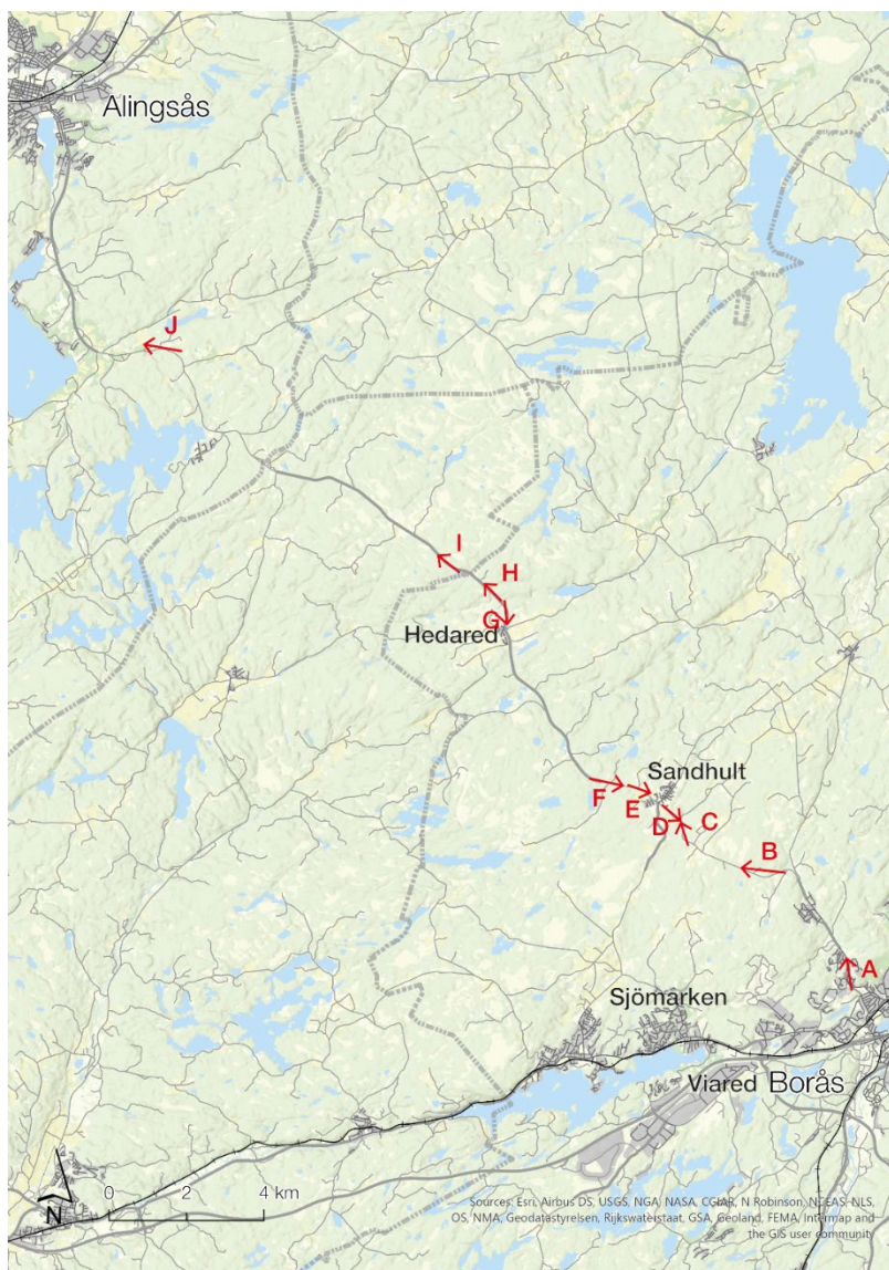
Figur 26 Tio sträckor där stigningsfält bedöms vara effektivt för att öka framkomligheten. Se åtgärd 16.
