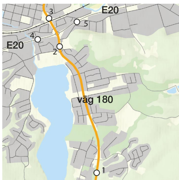
Figur 19 Punkter för trafikräkning som använts till trafikprognos för vägnät kring korsningen E20/väg 180 i Alingsås.
