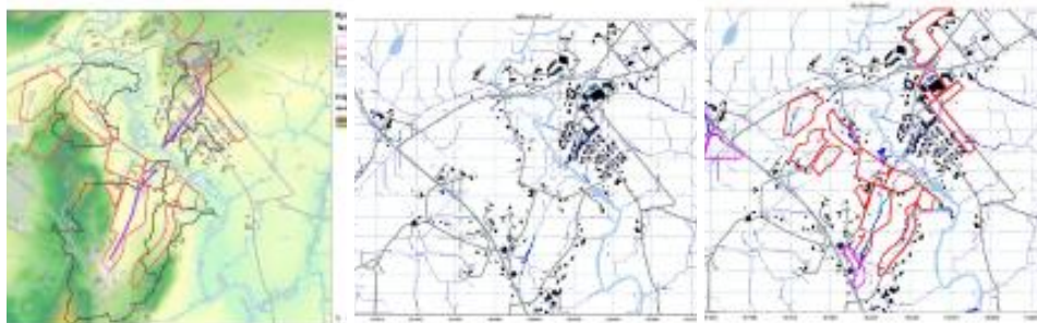
Avrinningsstråk Hyssna. De lila pilarna visar huvudstråken för avrinning med bedömd större avrinning. Avrinningsområden är markerade med svart gräns och instängda områden är streckade i grått. Översvämningsanalys Mark Nordväst, Tyréns 2015.
