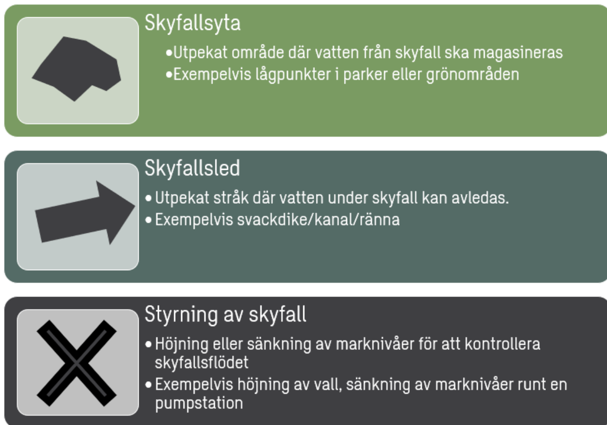
Figur 10. Schematisk illustration av tänkbara skyfallsåtgärder.
