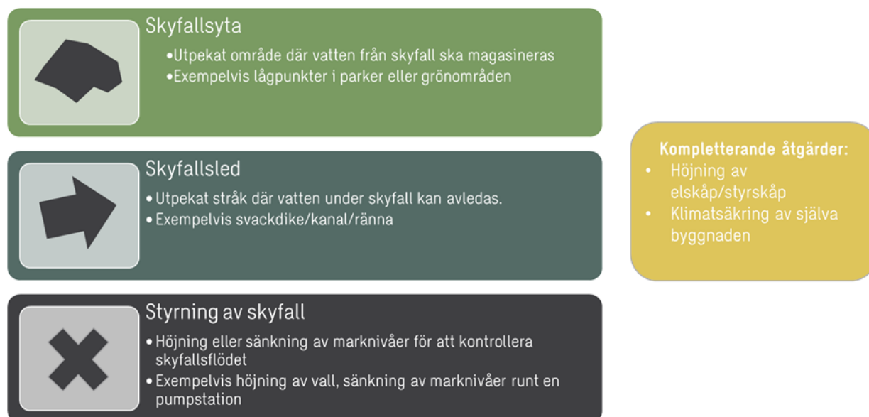
Figur 10. Schematisk illustration av tänkbara skyfallsåtgärder.
