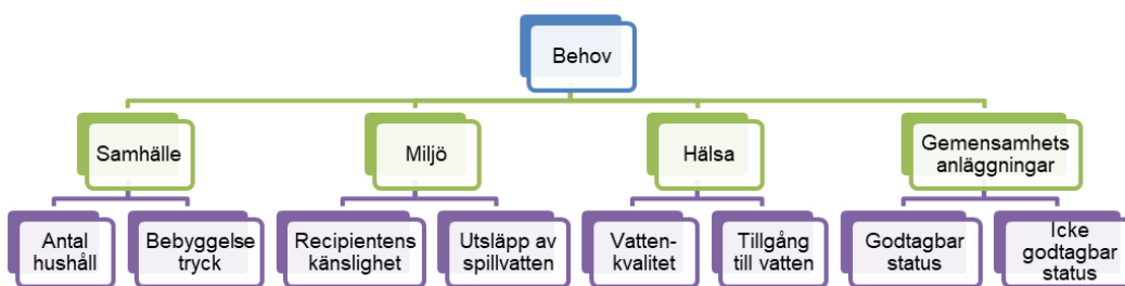
Figur 3 Kriterier vid bedömning av behov av förändrad vattenförsörjning eller avloppshantering.
